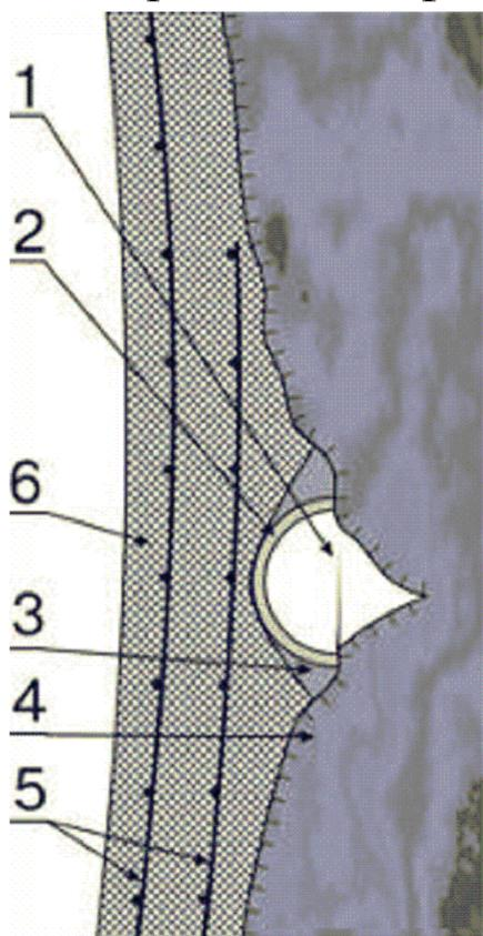
Рисунок А.13 - Пример устройства водоотвода в покрытии из торкрет-бетона: 1 – дренаж; 2 – желоб; 3 – быстросхватывающийся раствор; 4 – основание; 5 – арматурная композитная сетка; 6 – торкрет-бетон [7]
