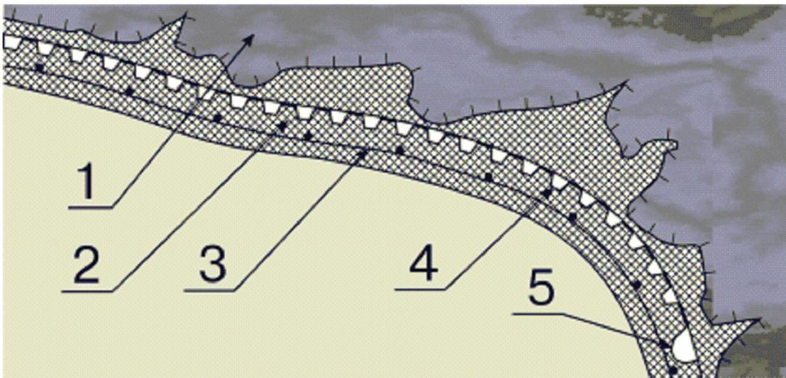
Рисунок А.12 - Поперечное сечение торкрет-бетонного покрытия с использованием в качестве водоотвода «дренажной» фольги и желоба: 1 – основание; 2- торкрет-бетон; 3 – арматурная композитная сетка; 4 – «дренажная» фольга; 5 – желоб [7]
