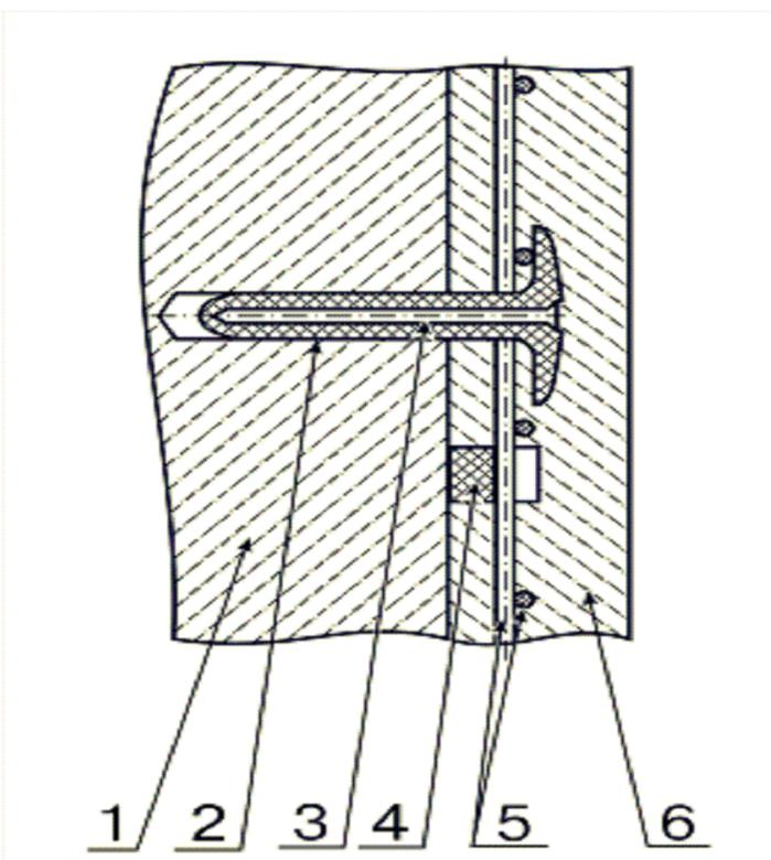
Рисунок А.6 – Крепление сеток композитных:
