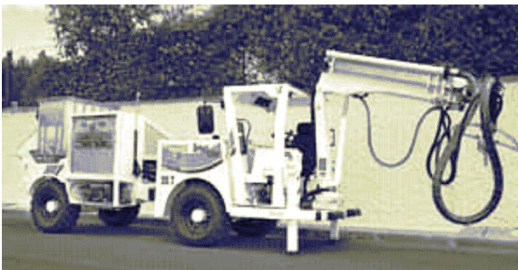
Рисунок А.18 – Малогабаритная торкрет-установка
