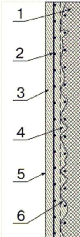
Рисунок А.15 - Восстановление бетонных поверхностей: 1 – старый бетон; 2 – арматурная композитная сетка; 3 – торкрет-бетон; 4 – восстановленный профиль; 5 – поверхность после затирки; 6 – очищенная и пескоструйно обработанная поверхность старого железобетона [7]
