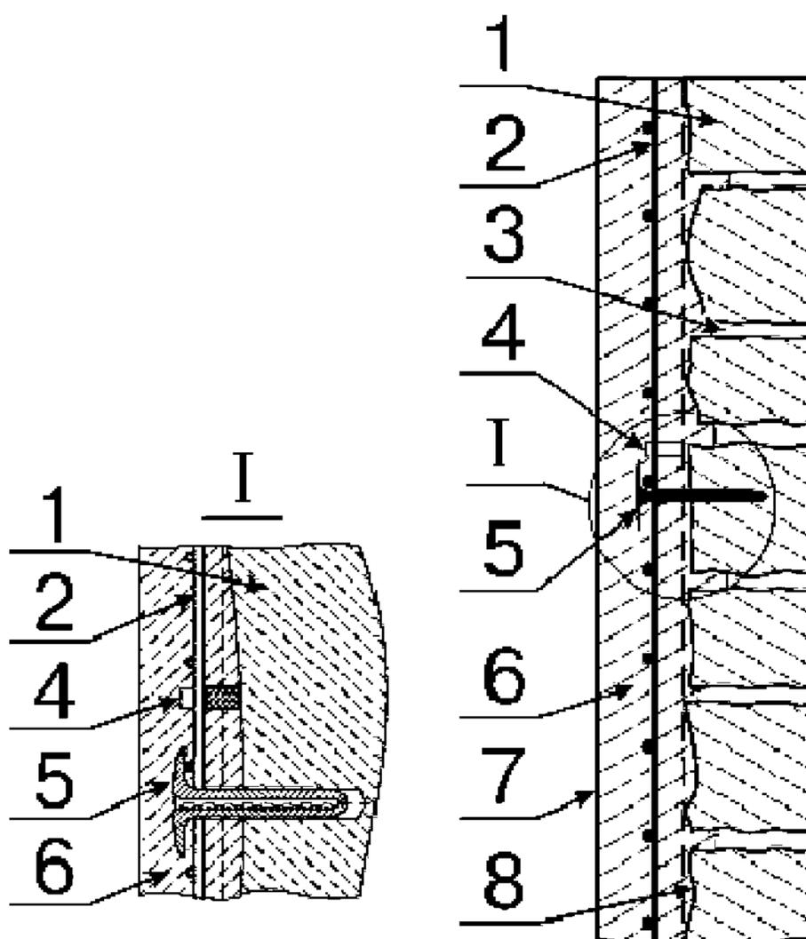
Рисунок А.16 - Восстановление кладки из кирпича или строительного камня:
