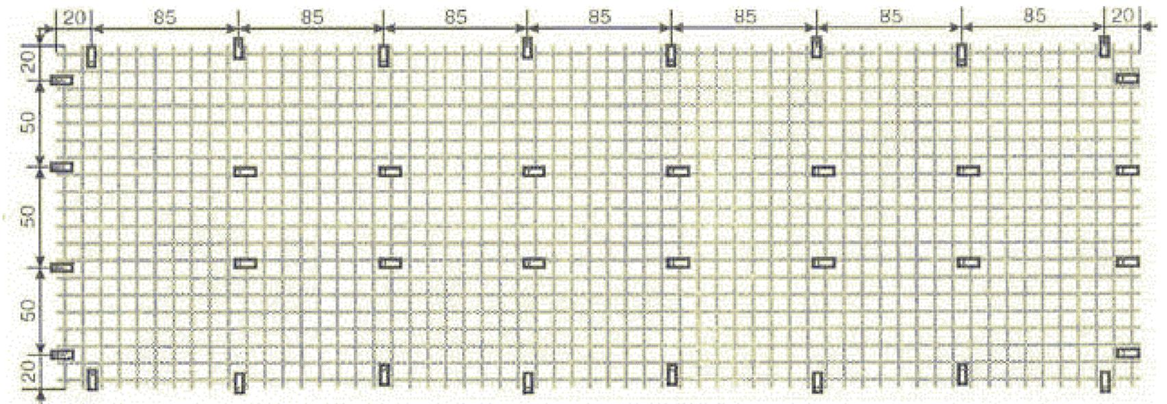
Рисунок А.3 - Схема крепления карты монтируемой сетки
