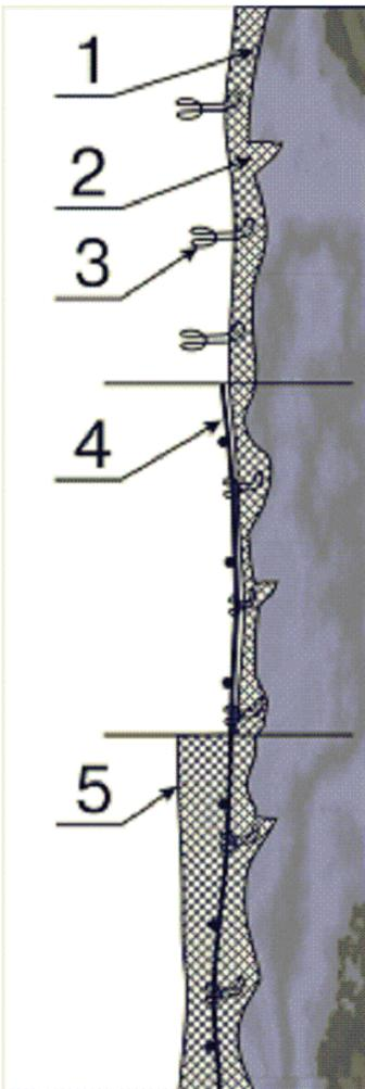
Рисунок А.5 - Крепление композитной сетки вязальной проволокой:
