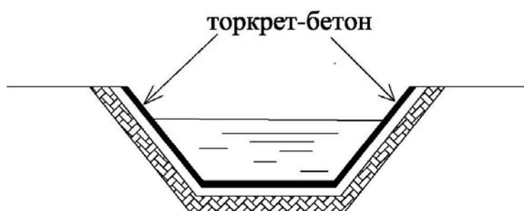
Рис. 2. Торкретирование откосов и днища канала
