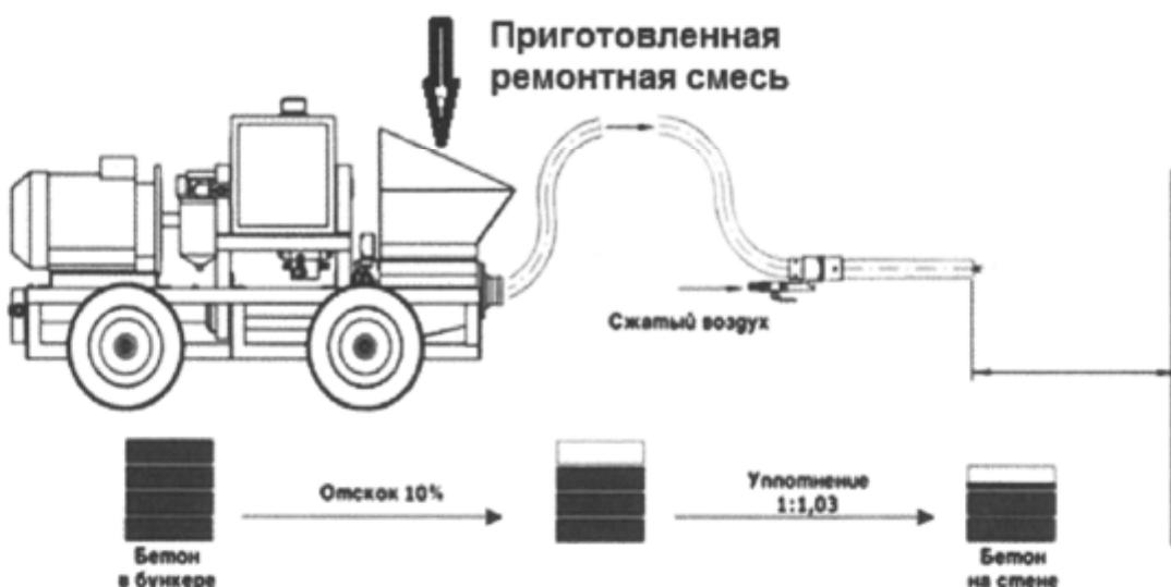
Рисунок 10.2. Принципиальная схема нанесения готовой смеси методом «мокрого» набрызга.
