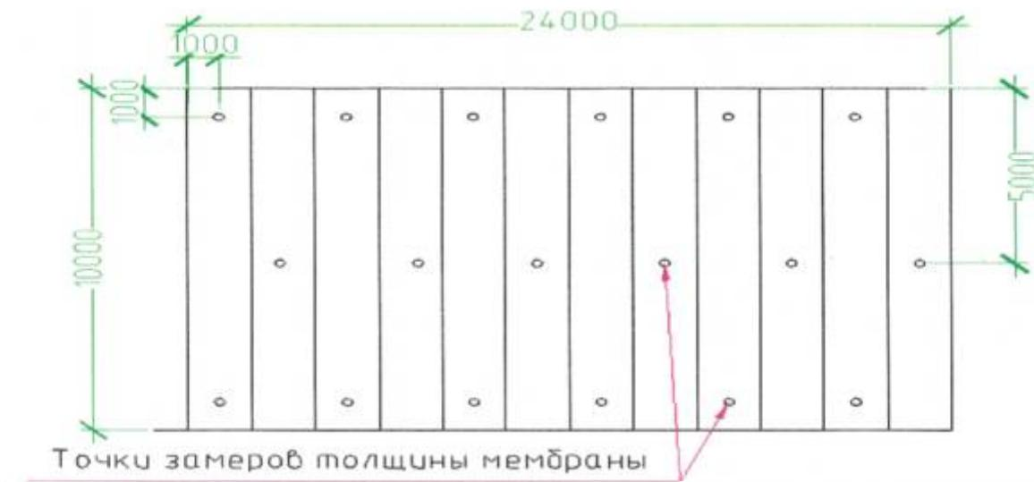
Рисунок 9.7 Сетка расположения точек замера толщины мембранны.
