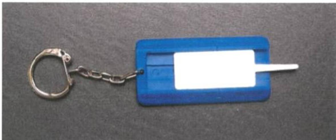
Рисунок 9.6 Контроль толщины слоя, может производится простым измерительным прибором, показанном на рисунке.
