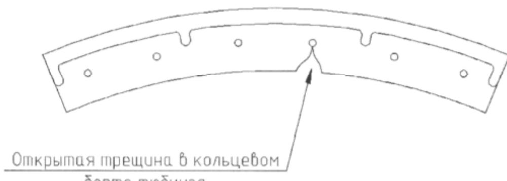
Рис. 3.6 – Схемы дефектов тюбинговой обделки
