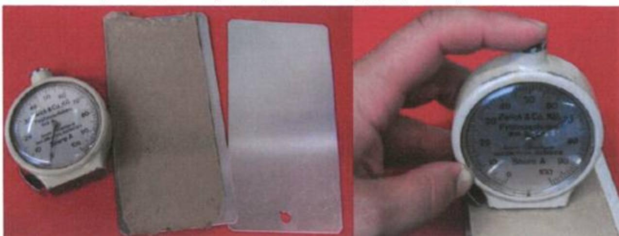
Рисунок 9.3 Устройство для замеров твердости по Шору.
